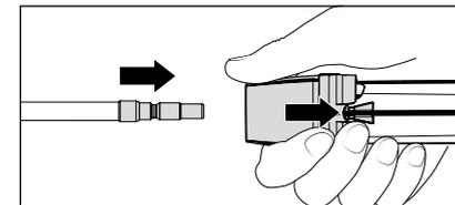
5. El manguito de pistola de desconexión de seguridad debe primero retirarse y luego introducirse la lanza en el acoplamiento insertable de la pistola de desconexión de seguridad.
