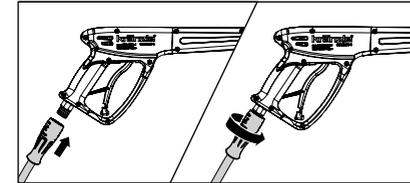
4. Enchufar la manguera de alta presión en la pistola con desconexión de seguridad, firmemente y estanca bajo presión.
