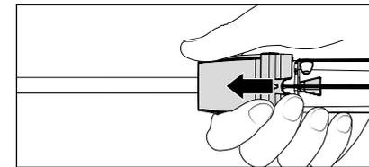
6. Después de insertar la lanza, debe soltarse el manguito de seguridad y prestarse atención a que el alojamiento de la lanza sea seguro. **Lubricar periódicamente la boquilla enchufable con una grasa libre de aceites.**
