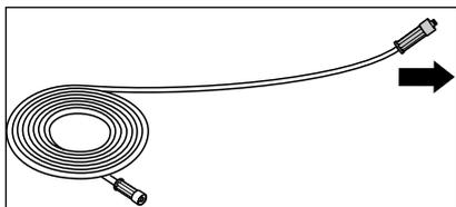
2. Desenrollar la manguera de alta presión recta exenta de bucles. (¡En caso de prolongación de la manguera de alta presión observar una longitud máxima de 20 m!)
