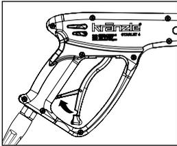
Después de cada uso, accionar el trinquete de seguridad situado en la pistola de desconexión de seguridad, a fin de imposibilitar el pulverizado involuntario.
