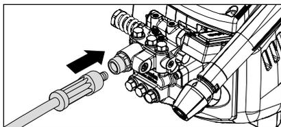
3. Atornillar la manguera de alta presión contenida en el volumen de suministro, a la salida de la bomba de forma firme y estanca bajo presión.
