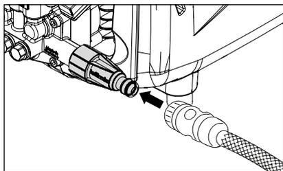
**8.** Raccorder le tuyau d'eau au manchon d'entrée d'eau avec filtre (Exigences minimales: tuyau de 5 m de longueur, section de 3/4", 10 bars). Le nettoyeur peut être raccordé, au choix, à une conduite d'eau froide ou d'eau chaude de 60 °C max. (1 à 10 bars de pression d'alimentation).
