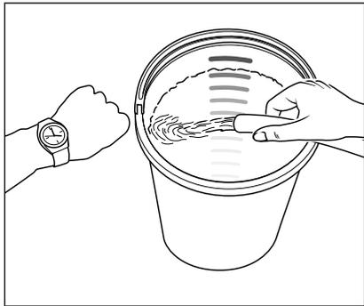
Le manque d'eau se produit bien plus souvent qu'on le croit. Plus un appareil est puissant, plus le risque de manque d'eau est important. Le manque d'eau produit une cavitation dans la pompe haute pression (mélange eau-air), ce qu'on ne remarque généralement pas ou trop tard. **Ceci conduit à une détérioration de la pompe haute pression.** Pour contrôler le débit d'eau de la conduite d'alimentation, il suffit de laisser s'écouler l'eau durant une minute dans un seau doté d'une échelle graduée.
