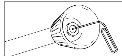
Si le problème persiste, enfoncer un fil de fer (un trombone) avec précaution dans la perforation de la buse. Si la buse reste obturée après une tentative de nettoyage avec un fil métallique, il est alors nécessaire de remplacer la lance.
