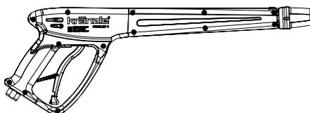
2. Pistolet Marche/Arrêt de sécurité avec poignée isolante et raccord rapide
