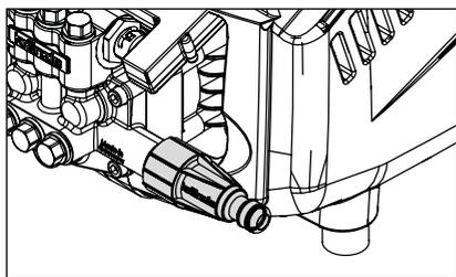
**7. Avant chaque mise en service, vérifier si le filtre d'entrée d'eau est propre.**
