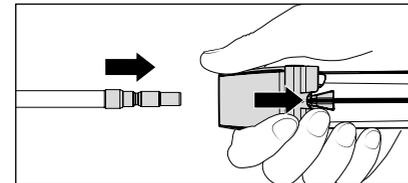
5. Tirer tout d'abord vers l'arrière la douille d'enclenchement du pistolet avant d'insérer la lance dans le raccord rapide.
