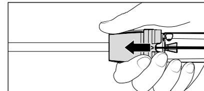
6. Après insertion de la lance dans le raccord, relâcher la douille et vérifier si la lance est bien enclenchée. **Graisser régulièrement le raccord baïonnette avec une graisse sans acide.**
