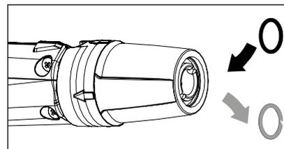
Arrêter l'appareil. Ouvrir brièvement le pistolet marche/arrêt de sécurité pour dépressuriser le système. Débrancher le flexible HP, le pistolet et la lance, puis contrôler l'état des joints d'étanchéité. Remplacer immédiatement les joints
