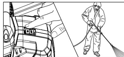
**10.** Mettre le nettoyeur haute pression en marche, le pistolet Marche/Arrêt de sécurité étant ouvert, puis chasser l'air du nettoyeur haute pression : A cet effet, ouvrir et fermer le pistolet à plusieurs reprises. Le nettoyeur haute pression est désormais prêt pour la réalisation des travaux de nettoyage.
