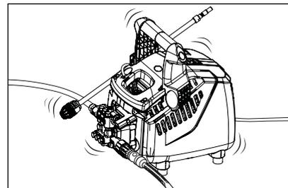
Après la fermeture du pistolet, le nettoyeur haute pression doit s'arrêter. Si ce n'est pas le cas, la cause peut être une fuite au niveau de la pompe, de l'interrupteur Start-Stop, du flexible haute pression, du pistolet ou de la lance.
