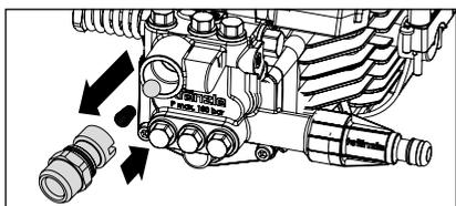
Enlever le barillet anti-retour et s'assurer que le joint torique n'est ni sale, ni endommagé. Contrôler également le siège d'étanchéité dans le carter de pompe haute pression et s'assurer qu'il n'est ni sale, ni endommagé.
