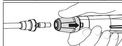
8. Después de insertar la lanza, debe soltarse el manguito de seguridad y prestarse atención a que el alojamiento de la lanza sea seguro. **Lubricar periódicamente la boquilla enchufable con una grasa libre de aceites.**
