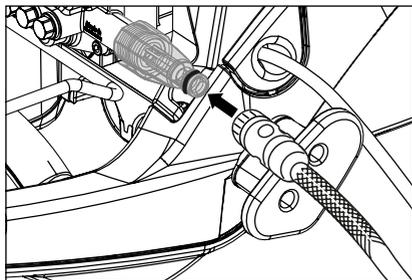
**10.** Conectar la manguera de agua al tamiz de la acometida de agua (requisitos mínimos: 5 m de longitud de manguera, sección transversal 3/4", 10 bares). La hidrolimpiadora de alta presión se puede conectar opcionalmente a una tubería de agua a presión (1 - 10 bares de presión previa) con agua fría o agua caliente hasta 60 °C.
