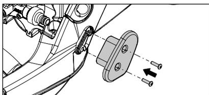
1. La mecanismo arrollador de cable inferior para el cable eléctrico debe atornillarse en el lugar previsto del bastidor con los tornillos incluidos en el volumen de suministro.
