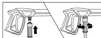
7. El manguito de pistola de desconexión de seguridad debe primero retirarse y luego introducirse la lanza en el acoplamiento insertable de la pistola de desconexión de seguridad.
