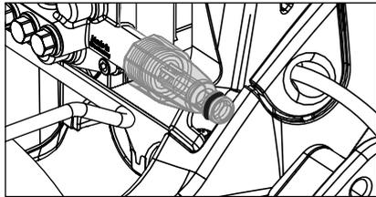
**9. Antes de cada puesta en servicio controlar el filtro de entrada de agua en cuanto a limpieza.** Si el filtro interior está sucio, desmontar el filtro y realizar el paso 9.1. Si el filtro está sucio, no puede pasar agua y no se puede cargar la presión.
