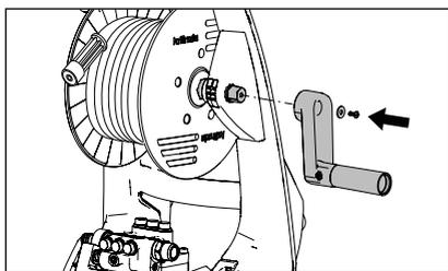
2. En las hidrolimpiadora de alta presión con tambor de manguera es preciso instalar la manivela adjunta antes de la primera puesta en funcionamiento. Ponga en pie para ello la hidrolimpiadora de alta presión. Enchufe la manivela en el eje hexagonal y fíjela con el disco y el tornillos adjunto.
