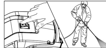
**12.** Conectar la hidrolimpiadora de alta presión con la pistola de desconexión de seguridad de pulverización abierta. Purgar el aire de la hidrolimpiadora de alta presión: abrir y cerrar varias veces la pistola. Iniciar el proceso de limpieza.
