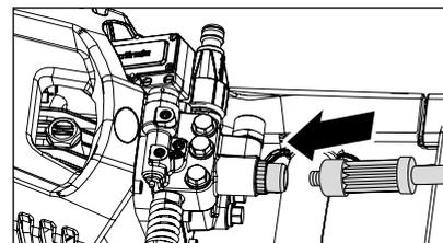
6. Enchufar la manguera de alta presión en la pistola con desconexión de seguridad, firmemente y estanca bajo presión.
