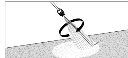
**13.** Para el uso del eliminador de suciedad debe prestarse atención a mantener la lanza hacia abajo al inicio.
