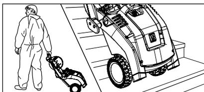
3. Desplazar la hidrolimpiadora de alta presión al lugar de utilización. El K 1050 TS/TST es una hidrolimpiadora de alta presión móvil con mecanismos de traslación robustos y apropiados para todo terreno y escaleras.
