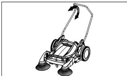
2. El arco de empuje se puede ajustar a la altura de trabajo deseada. Esto permite un trabajo ergonómico.
