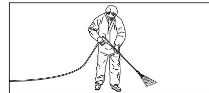
4. Al empezar el proceso de lavado, mantener abierta la pistola como mínimo 30 segundos sin dirigir el chorro de agua a presión sobre el objeto a limpiar. Es posible que el contenido de agua de la cámara de combustión tome alguna coloración durante el período de reposo.
