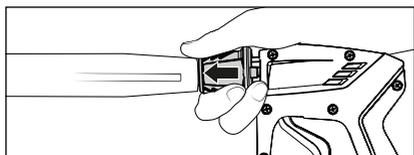
9. Después de insertar la lanza, debe soltarse el manguito de seguridad y prestarse atención a que el alojamiento de la lanza sea seguro. **Lubricar periódicamente la boquilla enchufable con una grasa libre de aceites.**
