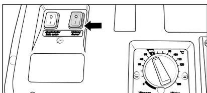
4. Conectar el interruptor de calefacción. El agua se calienta y se mantiene constante a la temperatura ajustada.
