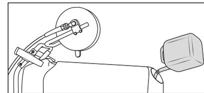
3. Antes de la puesta en servicio debe llenar el depósito con fuel-oil ligero. Fuel-oil (EL DIN 51 603) o combustible diésel (DIN EN 590). Capacidad de 25 litros.
