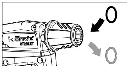
Desconecte la hidrolimpiadora de alta presión. Accione brevemente la pistola para el alivio de presión. Retire la manguera de alta presión, la pistola y la lanza. Controle los anillos de obturación. Si los anillos de obturación están defectuosos, cambiar de inmediato los anillos toroidales.
