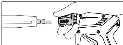
8. El manguito de pistola de desconexión de seguridad debe primero retirarse y luego introducirse la lanza en el acoplamiento insertable de la pistola de desconexión de seguridad.
