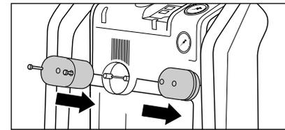
1. Monte los soportes del cable de alimentación con los tornillos.
