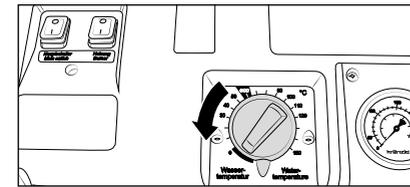
1. Ajuste la temperatura en el termostato a "0".
