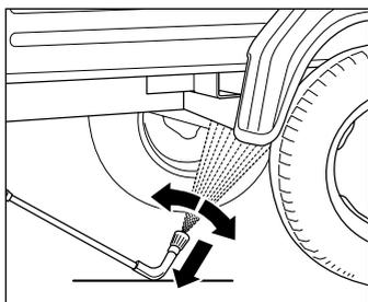
¡Es imprescindible apoyar la lanza para los bajos! ¡Se debe observar que en las lanzas de pulverización curvas o acodadas, se genera un considerable par en la reacción! (La lanza para los bajos es una pieza accesoria y puede ser adquirida opcionalmente)
