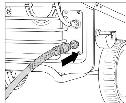
11. Conectar la manguera de agua a la entrada de agua correspondiente (requisitos mínimos: 5 m de longitud de manguera, sección transversal 3/4", 10 bares). La hidrolimpiadora de alta presión se puede conectar opcionalmente a una tubería de agua a presión (1 - 10 bares de presión previa) con agua fría o agua caliente hasta 60 °C. En la therm 1017 de elevada potencia existe la posibilidad de aspirar agua de un recipiente (véase Aspiración directa).
