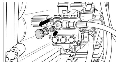
Retirar el cuerpo de retención y comprobar que la junta tórica no presente suciedad o deterioro. Examine también el asiento estanqueizante en la caja de la bomba para comprobar que no presente suciedad o deterioro.
