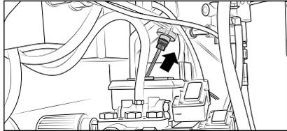
13. **Antes de cada puesta en servicio, controlar el indicador del nivel de aceite en la barra de medición.** El nivel de aceite debe alcanzar el borde superior de la marca "OK". Véase el capítulo „Cuidado y mantenimiento“ en esta manual de instrucciones.
