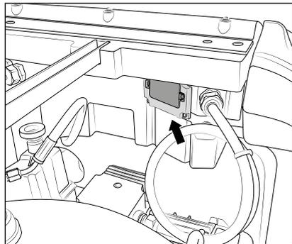
Como dispositivo adicional de seguridad la hidrolimpiadora de alta presión está provista de un sensor de sobret temperatura en la abertura de gases de escape. Si algún dispositivo de seguridad como por ejemplo el controlador de flujo está defectuoso, o el quemador sigue calentando a pesar que el serpentín de calefacción no evacua calor, la consecuencia sería una destrucción del serpentín.
