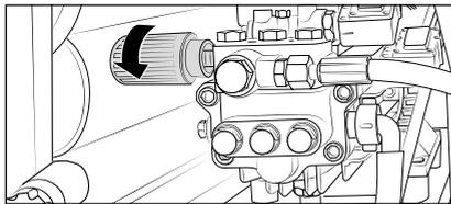
16. Regular de forma continua con el volante la presión de trabajo. La presión máxima a disposición está ajustada de fábrica.
