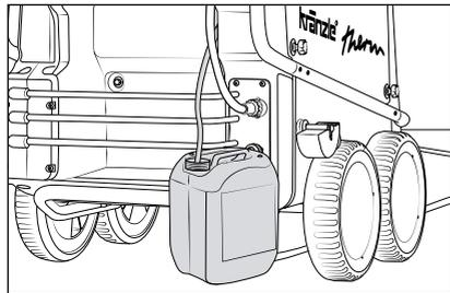
1. Enchufar la manguera del inyector de detergente con aditivo.
