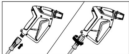
7. Conecte la atornilladura giratoria de color gris de la manguera de alta presión a la pistola de desconexión de seguridad. A continuación, enrósquelas fuertemente y a presión.
