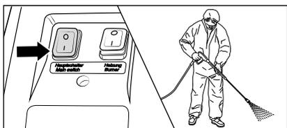
3. Conectar la hidrolimpiadora de alta presión con la pistola de desconexión de seguridad de pulverización abierta. Purgar el aire de la hidrolimpiadora de alta presión: abrir y cerrar varias veces la pistola.
