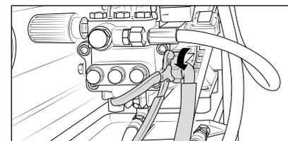
1. Desatornillar la manguera de unión entre la bomba de alta presión y la caja de agua.
