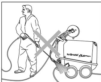
¡Nunca dirigir el chorro de alta presión sobre la hidrolimpiadora de alta presión! ¡No someter la hidrolimpiadora de alta presión a la niebla de pulverización del chorro de alta presión!
