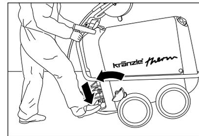
5. Las hidrolimpiadora de alta presión de la therm 1017 de elevada potencia son limpiadoras equipadas de ruedas todo terreno muy robustas. Para llevar la hidrolimpiadora de alta presión a la posición de desplazamiento, ejerza presión con el pie contra el apoyo de basculación y tire luego de la hidrolimpiadora hacia usted.
