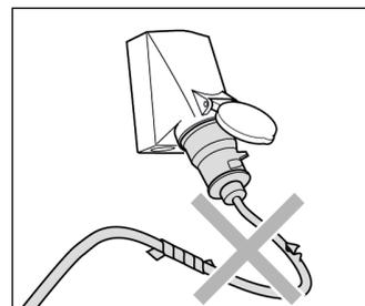
¡Utilizar el cable eléctrico solamente en perfecto estado! Los cables no deben dañarse (arrastrarse, aplastarse, arrollarse, ...) ni repararse inadecuadamente.
