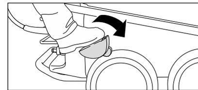
4. Para poder desplazar la hidrolimpiadora de alta presión al lugar de utilización, suelte el freno de inmovilización. No debe tirarse de la hidrolimpiadora de alta presión con la manguera de alimentación de agua conectada.
