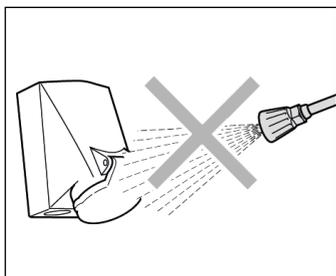
¡No dirigir el chorro de alta presión hacia cajas de enchufe u otros dispositivos eléctricos! Todos los componentes conductores de corriente situados en la zona de trabajo deben estar protegidos contra las salpicaduras de agua.
