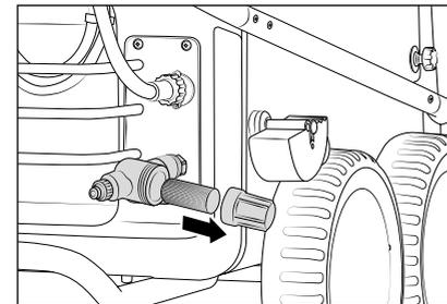
10. Antes de cada puesta en servicio controlar el filtro de entrada de agua en cuanto a limpieza. Desenrosque la copa del filtro manualmente, retire el filtro de entrada de agua y realice un enjuague y limpieza a fondo con las demás partes bajo agua limpia. Si el filtro está sucio, no puede pasar agua y, por tanto, no se genera presión.
