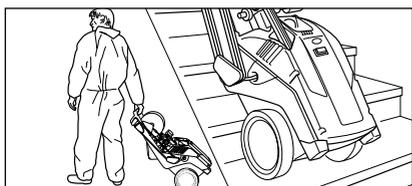
3. Déplacer le nettoyeur haute pression vers le lieu de mise en œuvre. La série K 1152 est un appareil mobile équipé de roues tout terrain très robustes permettant de franchir sans peine trottoirs et escaliers.
