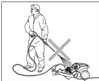
Ne pas nettoyer le nettoyeur haute pression avec le jet haute pression ou diriger le brouillard du jet de pulvérisation sur le nettoyeur haute pression !
