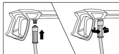
5. Brancher le raccord gris pivotant du flexible HP sur le pistolet Marche/Arrêt de sécurité, puis les visser fermement entre eux pour établir un raccordement étanche à la pression.
