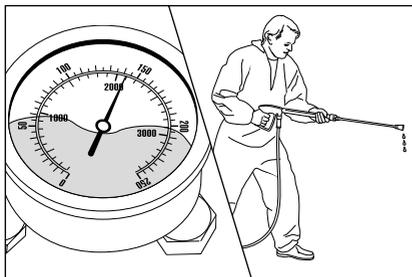
Le manomètre avec boîtier inox indique pleine pression. Cependant, l'eau ne sort pas ou ne sort que goutte à goutte de la lance.
