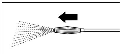
2. Pousser la buse Vario-Jet vers l'avant pour le réglage en basse pression afin de permettre à l'injecteur d'aspirer le produit de nettoyage.
