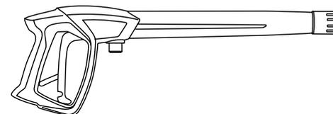
2. Pistolet Marche/Arrêt de sécurité avec raccord à vis
