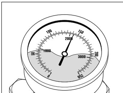
Après la fermeture Pistolet Marche/Arrêt de sécurité, le nettoyeurs haute pression doit s'arrêter et le manomètre avec boîtier inox doit alors indiquer „0“ bar. Si le nettoyeur ne s'arrête pas et que le manomètre avec boîtier inox continue à indiquer pleine pression, la cause peut être une fuite au niveau de la pompe haute pression, du pressostat, du flexible haute pression ou du Pistolet Marche/Arrêt de sécurité.
