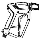
2. Sicherheits-Abschalt-pistole mit Steckkupplung
