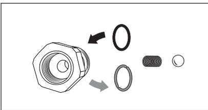
Sind die Dichtungsringe defekt, sofort O-Ringe austauschen.
