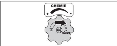
3. Durch Schließen des Reinigungsmittelventils wird die Zufuhr des Zusatzmittels gestoppt.
