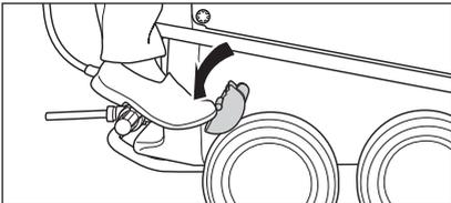
3. Um den Hochdruckreiniger zum Einsatzort bewegen zu können, lösen Sie die Feststellbremse.
