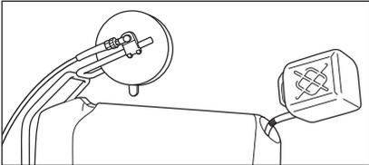
2. Füllen Sie vor Inbetriebnahme Heizöl in den Brennstofftank. (Heizöl EL DIN 51 603 oder Diesel (DIN EN 590) Füllmenge 25 Liter.
