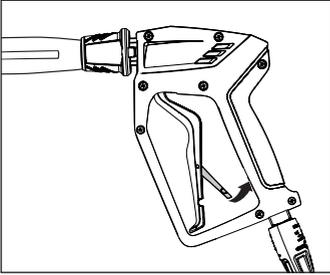
Sicherungssperre an der Sicherheits-Abschalt-pistole nach jedem Gebrauch umlegen, um unbeabsichtigtes Spritzen zu verhindern!
