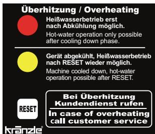
**Rot:** Übertemperatur ausgelöst, Gerät abkühlen lassen, Heißwasserbetrieb nicht möglich.
