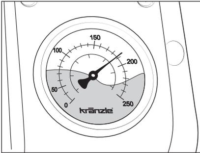
Nach dem Schließen der Sicherheits-Abschaltpistole muss sich der Hochdruckreiniger abschalten. Das Edelstahlmanometer muss den zulässigen Abschaltdruck anzeigen (siehe Typenschild). Wenn die Abschaltung nicht erfolgt und das Edelstahlmanometer weiterhin vollen Druck anzeigt (Gerät schaltet nicht in den Bypass), kann Leckage an der Hochdruckpumpe, am Druckschalter, am Hochdruckschlauch, oder an der Sicherheits-Abschaltpistole die Ursache sein.
