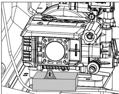
Der erste Ölwechsel muss nach ca. **50 Betriebsstunden** erfolgen. Weitere Ölwechsel sind jährlich oder nach 500 Betriebsstunden erforderlich. Nimmt das Öl einen grauen oder weißlichen Farbton an, so muss dieses auf jeden Fall gewechselt werden.
