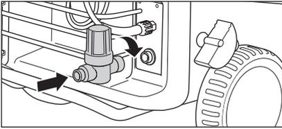
1. Montieren Sie den Wassereingangsfilter am Wassereingang.
