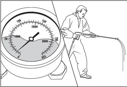
Das Edelstahlmanometer zeigt trotz aufgedrehter Druckregulierung nur wenig Druck. Aus der Lanze kommt ein unregelmäßiger Strahl. Der Hochdruckschlauch vibriert.
