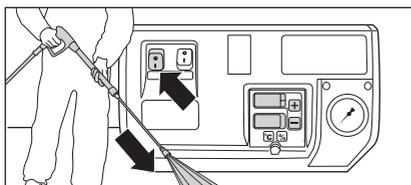
2. Hochdruckreiniger bei geöffneter Sicherheits-Abschaltpistole einschalten. Den Hochdruckreiniger entlüften: Sicherheits-Abschaltpistole mehrmals öffnen und schließen. Mit dem Reinigungsvorgang beginnen.
