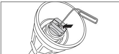
Besteht das Problem weiter, so durchstoßen Sie mit einem Draht (Büroklammer) vorsichtig die Düsenöffnung. Sollte das Reinigen mit einem Draht nicht den gewünschten Erfolg bringen, so muss die Düse ersetzt werden.
