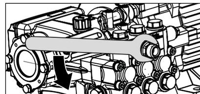
**Forma de proceder:** Desconectar la hidrolimpiadora de alta presión, desconectar la clavija de la red. Cerrar la alimentación de agua. Accione brevemente la pistola de desconexión de seguridad para el alivio de presión. Desatornillar la salida de la bomba.
