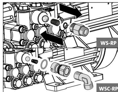
Retirar el cuerpo de retención y comprobar que la junta tórica no presente suciedad o deterioro. Examine también el asiento estanqueizante en la caja de la bomba para comprobar que no presente suciedad o deterioro.
