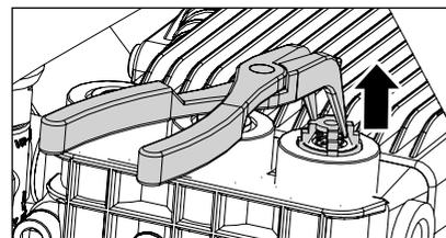
Retire con una pinza de punta el cuerpo de válvula (con revestimiento de plástico de color verde o rojo) junto con el anillo toroidal. Controle el anillo de obturación en cuanto a deterioro. En caso de deterioro se debe cambiar el anillo toroidal.
