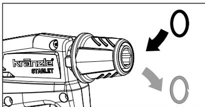
Desconecte la hidrolimpiadora de alta presión. Accione brevemente la pistola para el alivio de presión. Retire la manguera de alta presión, la pistola y la lanza. Controle los anillos de obturación. Si los anillos de obturación están defectuosos, cambie de inmediato los anillos toroidales.
