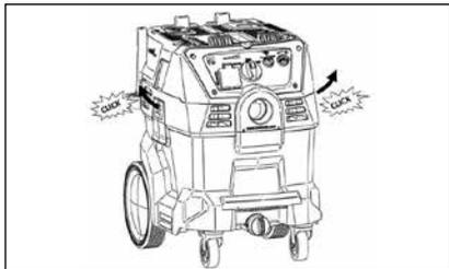
1. Las toberas y los accesorios del equipo se colocan dentro del recipiente para su envío. Para abrir el recipiente, tire de las abrazaderas hacia fuera con algo de fuerza. A continuación, retire el cabezal.
