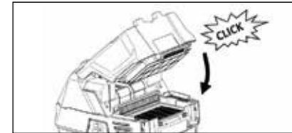
5. Cierre la tapa del filtro: Retire la tapa sujetando por el asa de la tapa del filtro (D) o por el asidero (A) con una mano. Levante con cuidado la varilla (C) sobre el gancho de retención (B) con la otra mano y baje lentamente la tapa. Cuando la varilla (C) esté sobre el gancho de retención (B), retire la mano de la varilla (C) y cierre la tapa del filtro.
