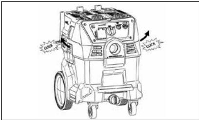
Retire el cabezal para introducir la bolsa de polvo. Para ello, tire de las abrazaderas hacia fuera con un poco de fuerza y levante el cabezal agarrándolo por el asidero.
