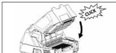
Para cerrar la tapa del filtro, eleve la tapa sujetando por el asa de la tapa del filtro (D) o por el asidero (A) con una mano. Levante con cuidado la varilla (C) sobre el gancho de retención (B) con la otra mano y baje lentamente la tapa. Cuando la varilla (C) esté sobre el gancho de retención (B), retire la mano de la varilla (C) y cierre la tapa del filtro.
